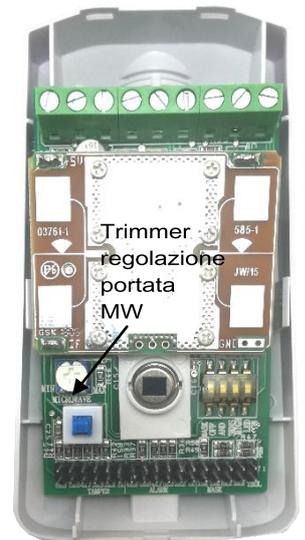
Sensibilità di rilevazione ridotta per entrambe le tecnologie. IR si ha la rilevazione con l'attraversamento di due semifasci. MW Velocità di rilevazione 0.5 sec. con movimento di 0.6 mt/sec.
